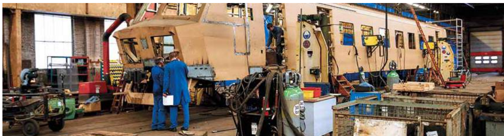
Een MR75-motorstel is volledig gestript en wordt vernieuwd.
