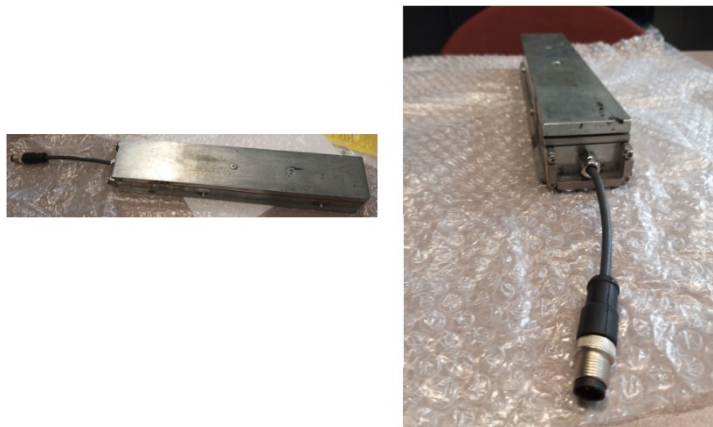
Figure 1 : Capteur pour la mesure de l'effort de freinage sur un disque.
