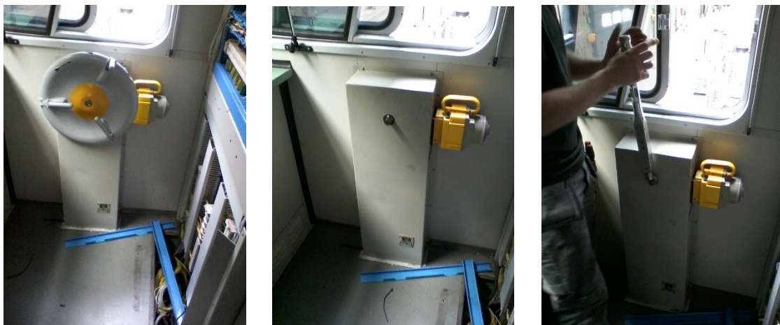
Figure 12 : Serrage du frein à vis avec une clé dynamométrique.
