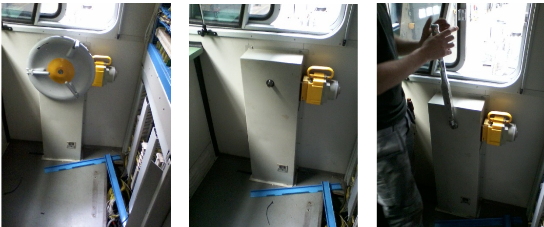
Figuur 12: Aanspannen van de schroefrem met een momentsleutel.
