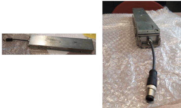
Figuur 1: Opnemer voor het meten van de remkracht op een schijf.
